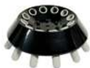
Cabezal angular | GBK016 12x15mL 4000rpm / 2250 xg Precio 222,74
